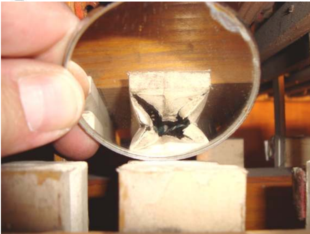
Zerrissene Stirnfalte an einem Barkerbalg
