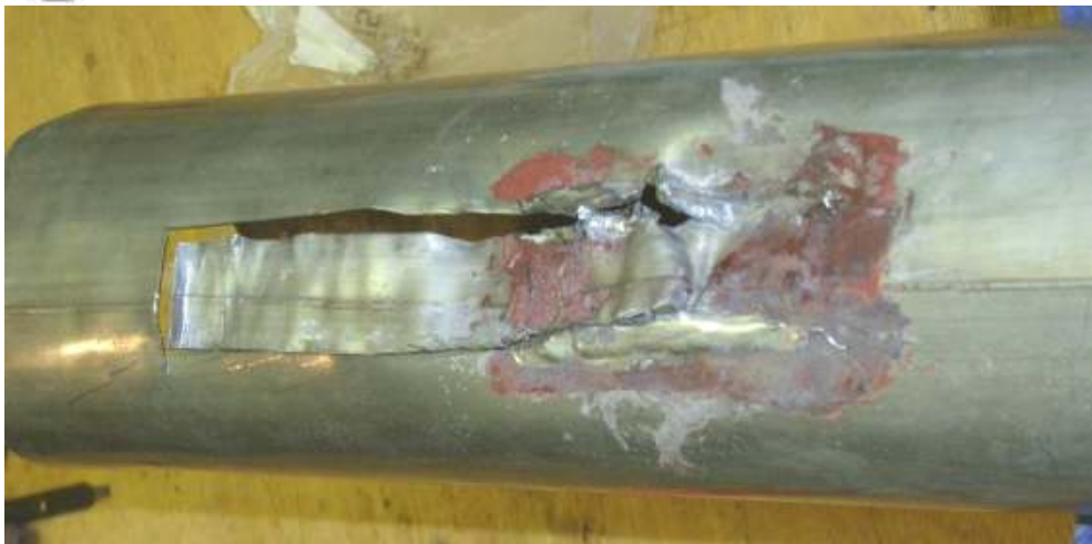
Deformierter Stimmschlitz vor der Restaurierung
