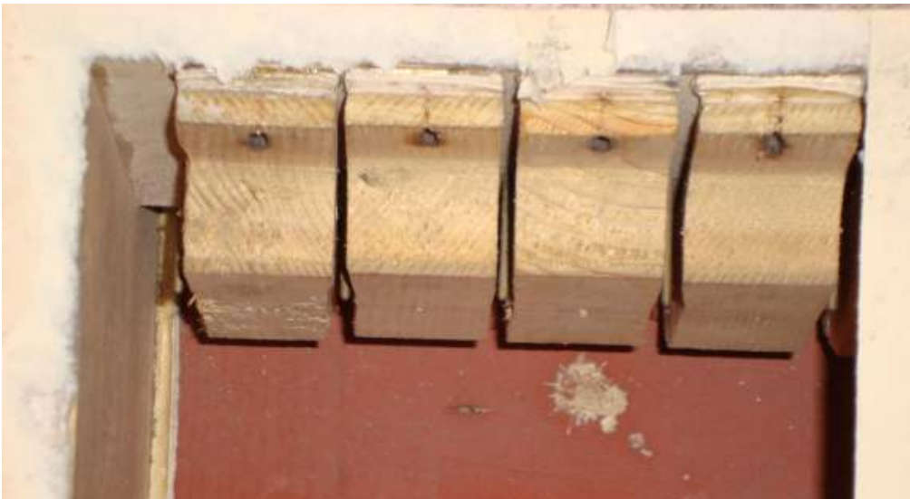
Hängeventile in der oben offenen Registerkanzelle
