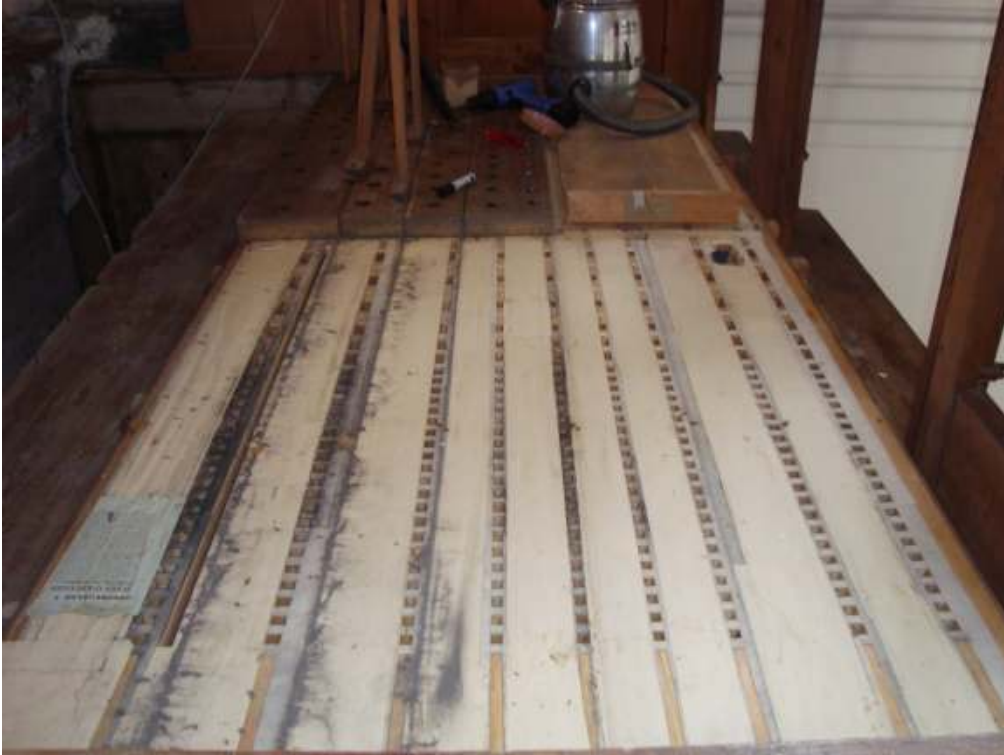
Hauptwerkklade ohne Stöcke
