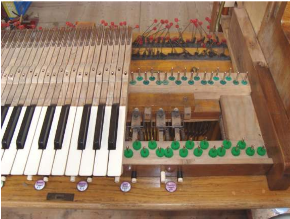
Einbau der Restaurierten Klaviaturen
