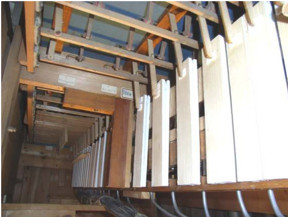
Neu belederte Barkerbälge nach der Restaurierung
