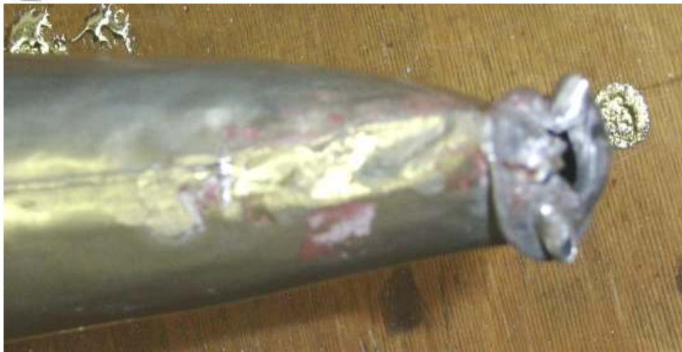
Deformierter Pfeifenfuss vor der Restaurierung
